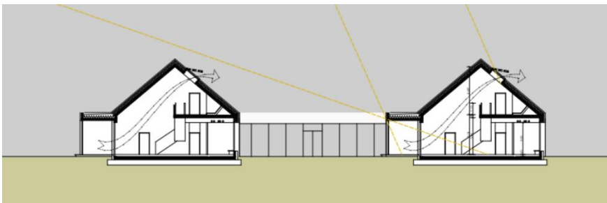
Kindergarten in Ragnitz, Belüftungskonzept, Copyright: h2
